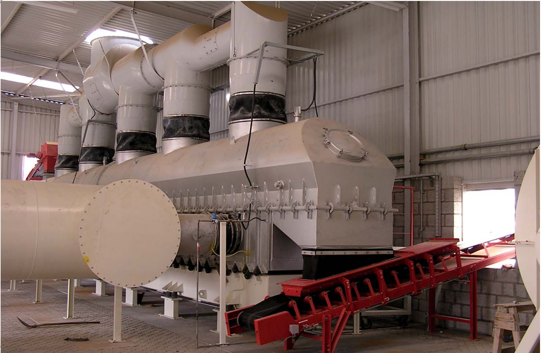
Afb. 1 Een wervelbeddroger voor de droging en koeling van mineralen, met een capaciteit van 65 ton/uur
